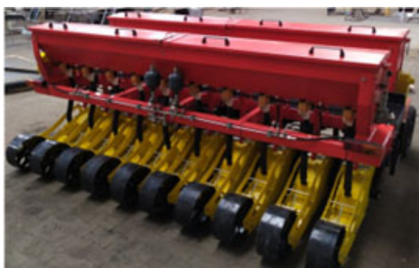
Agregat do pasowego podsiewu użytków zielonych ASP-1
